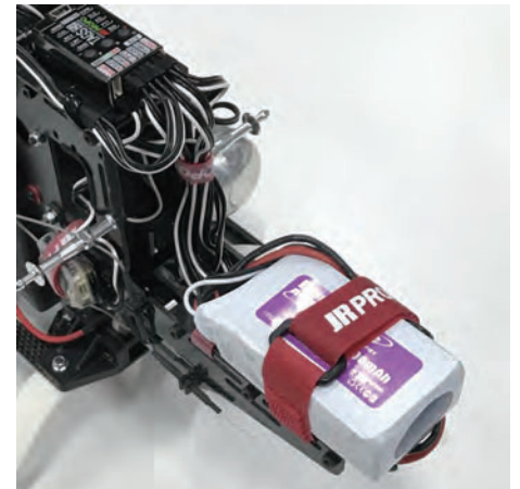
バッテリーをフロントベッドにマジックテープで固定して搭載
