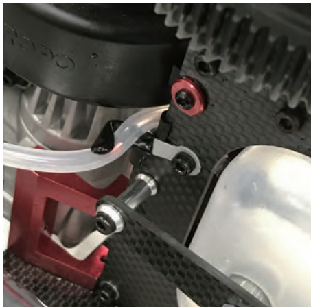
コードホルダーで配線や燃料チューブをホールドして振動対策
