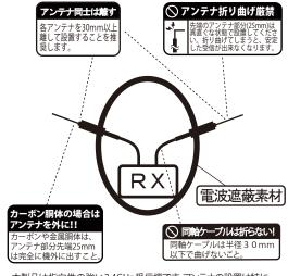
本製品は指向性の強い2.4GHz 受信機です、アンテナの設置は特に 重要ですので上記の注意をよく読んで正しく設置する様にして下さい。
