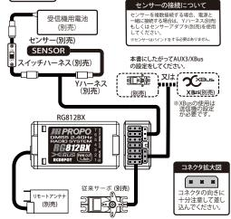
※カーボン製などの受信状態が悪い機体への搭載の場合には、リモートアンテナを接続 することを推奨いたします。リモートアンテナを使用する場合は、リモートアンテナ を接続した状態でバインドを行ってください。
