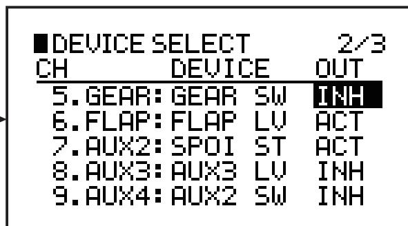
AUX2 から GEAR のミキシングを下図のように設定
