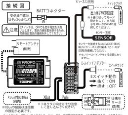
※ハイボルテージ又は、ワイドボルテージサーボは、直接接続可能です。4.8Vで駆動するサーボの場合には 市販のレギュレーター(4.8~5.5V出力)を介して接続してください。
