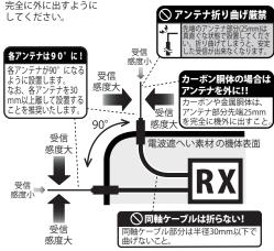
本製品はアンテナダイバーシティ受信機です、アンテナの設置は特に 重要ですので上記の注意をよく読んで正しく設置する様にして下さい。
