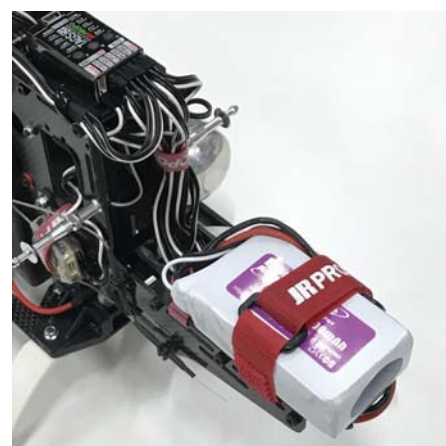
バッテリーをフロントベッドにマジックテープで固定して搭載
