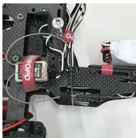
2.4GHz受信機のアンテナは直行軸になる様に設置
