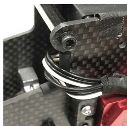
エッジプロテクターでフレームと配線の接触面をカバー
